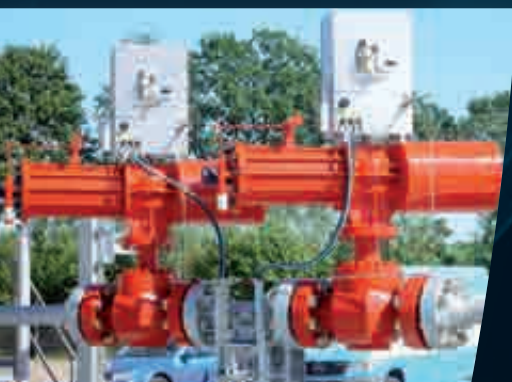
Аварийная арматура быстрого срабатывания для применения в условиях Сероводорода
